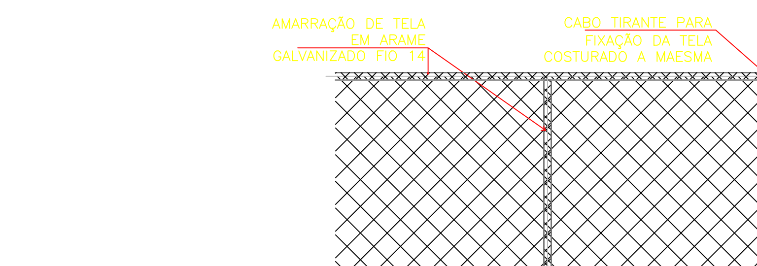
DETALHE 1 FIXAÇÃO DA TELA SEM ESCALA
